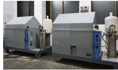
【塩水噴霧試験機】 塩水噴霧により腐食を加速して耐食性を確認する装置
