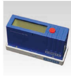
【光沢計】 塗装表面の光沢(光の反射によって生じるツヤ)を測定する装置
