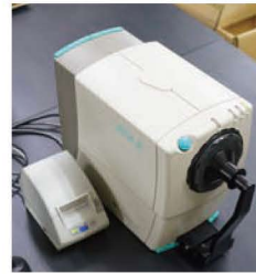
【分光光度計(色差計)】 色彩の3原色を数値化し基準色との差を測定する装置
